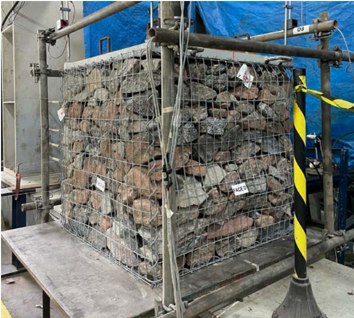
Ensaio de compressão do gabião Easy Seção de Obras Cíveis do IPT/SP
