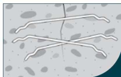
Ancoragem do gancho e a resistência à tração do fio foram especificamente projetadas para atuar em fissuras entre 0,1 e 0,3 mm.
