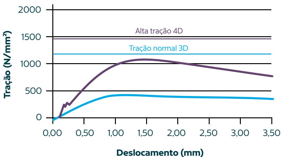
O teste de tração mostra claramente as diferenças de funcionamento dos dois tipos de fibra Dramix®. A ancoragem nas séries 3D e 4D deforma-se lentamente durante o processo de tensionamento.
